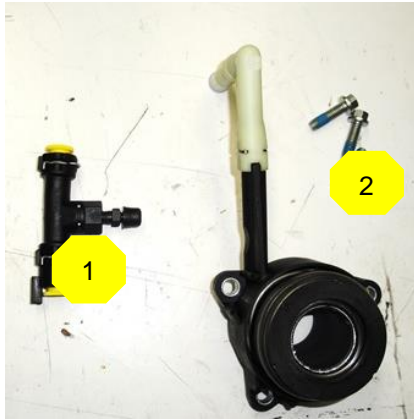
1.) Clutch clip-on 2.) Slave cylinder
