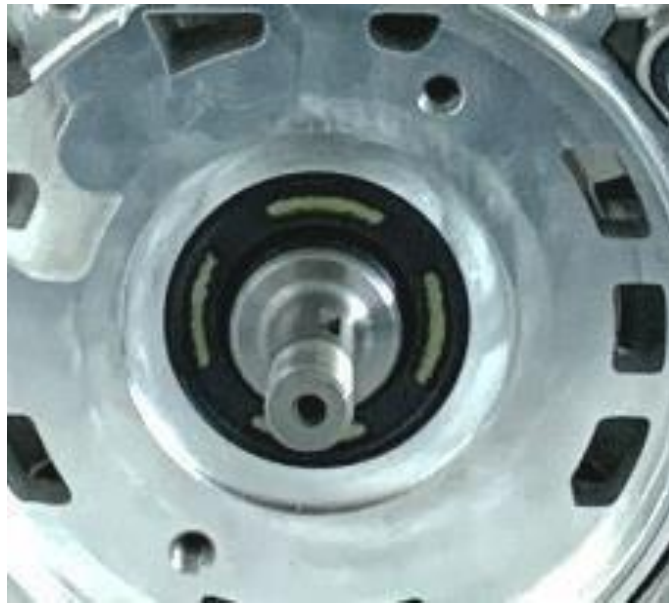
FOTO DEL DETTAGLIO DELLA POSIZIONE PARAOLIO ALBERO MOTORE DETAIL PHOTO OF THE CRANKSHAFT OIL SEAL POSITION PHOTO DE DÉTAIL DE LA POSITION DU JOINT D'HUILE DU VILEBREQUIN
