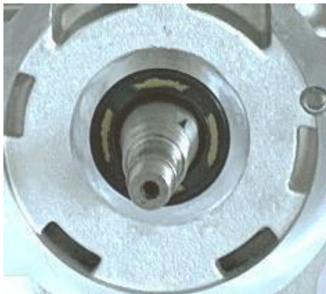
FOTO DEL DETTAGLIO DELLA POSIZIONE PARAOLIO ALBERO MOTORE DETAIL PHOTO OF THE CRANKSHAFT OIL SEAL POSITION PHOTO DE DÉTAIL DE LA POSITION DU JOINT D'HUILE DU VILEBREQUIN
